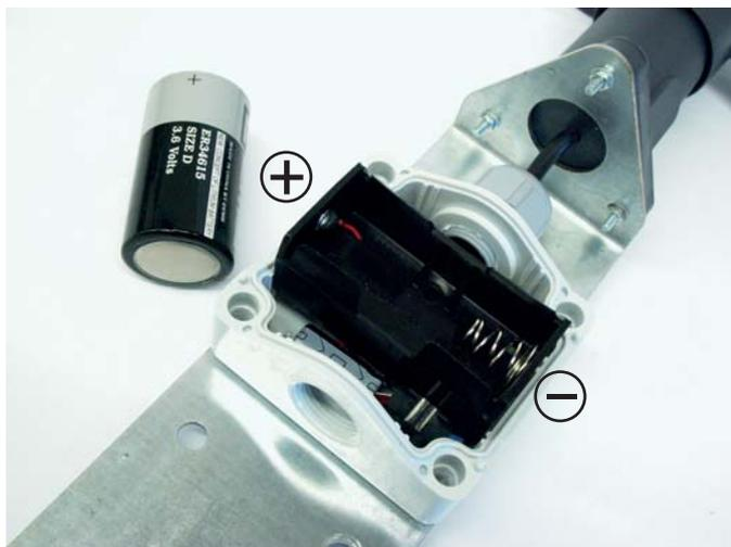
Para poner o cambiar la pila, quitar la tapa de la caja con un destornillador. La pila de litio va alojada en un portapilas. Al poner la tapa, apretar bien los tornillos.
